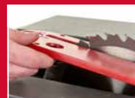
Zapadki zapobiegające odbiciu zatrzymują materiał chroniąc użytkownika
