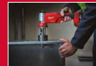
WYKONANIE OTWORU - Wystarczy pociągnąć za spust w celu rozpoczęcia łatwego wycinania otworów
