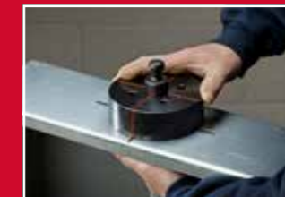
Dobra widoczność miejsca pracy dzięki podziałce na matrycy umożliwia szybkie i dokładne zastosowanie
