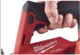
Włacznik z prostą i szybką zmianą prędkości przesuwu brzeszczota
